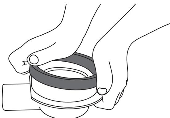
**2)** L'anneau de sécurité contenant le joint d'étanchéité est inséré sur la partie haute du siphon. Il doit être enfoncé à fond.
