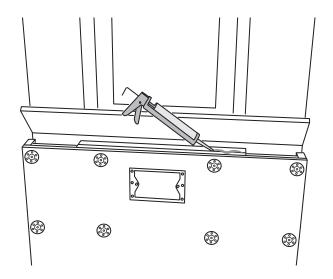
**3)** Après la découpe, le panneau supérieur est collé avec une colle de montage appropriée (par ex. colle de montage JACKODUR®, BOARD-FIX®).
