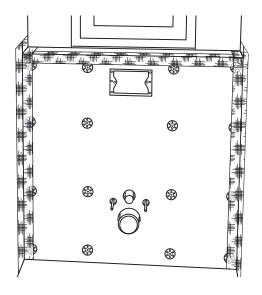
**4)** Tous les bords sont mastiqués avec une bande d'armature appropriée (par ex. bande d'armature JACKOBOARD®).
